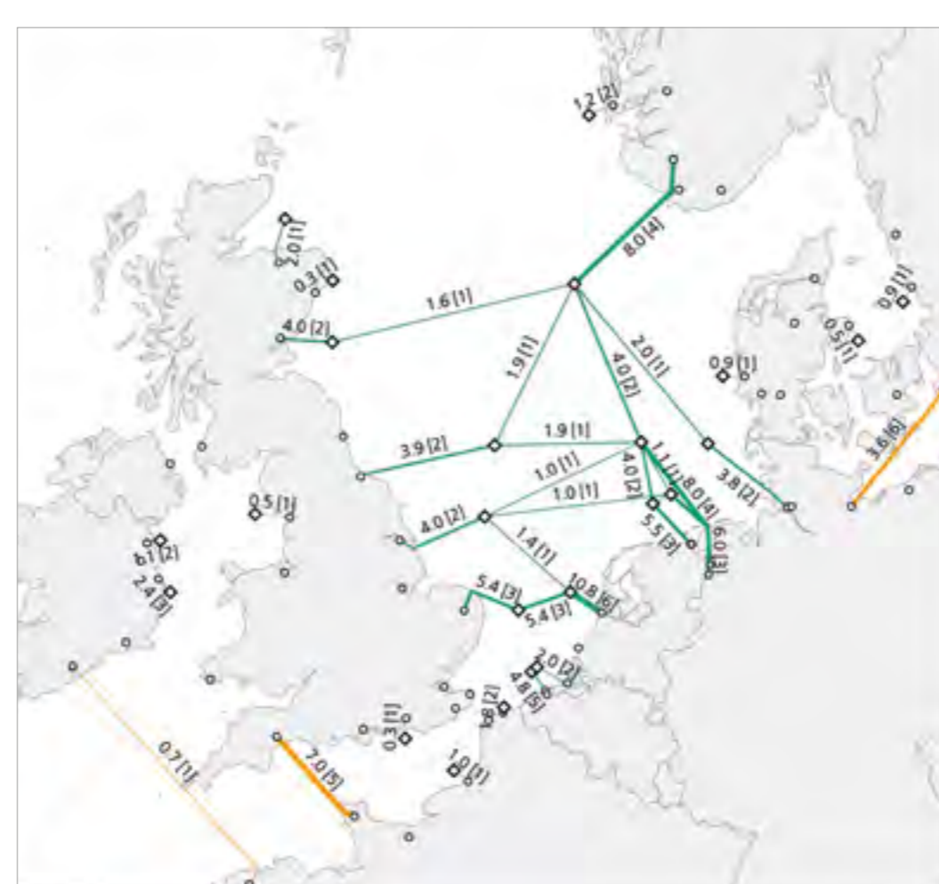
Durch die marktbasierte Netzplanung ermittelte Offshore-Netze (Variante »Meshed Grid« für das NSON-2050-Szenario).
