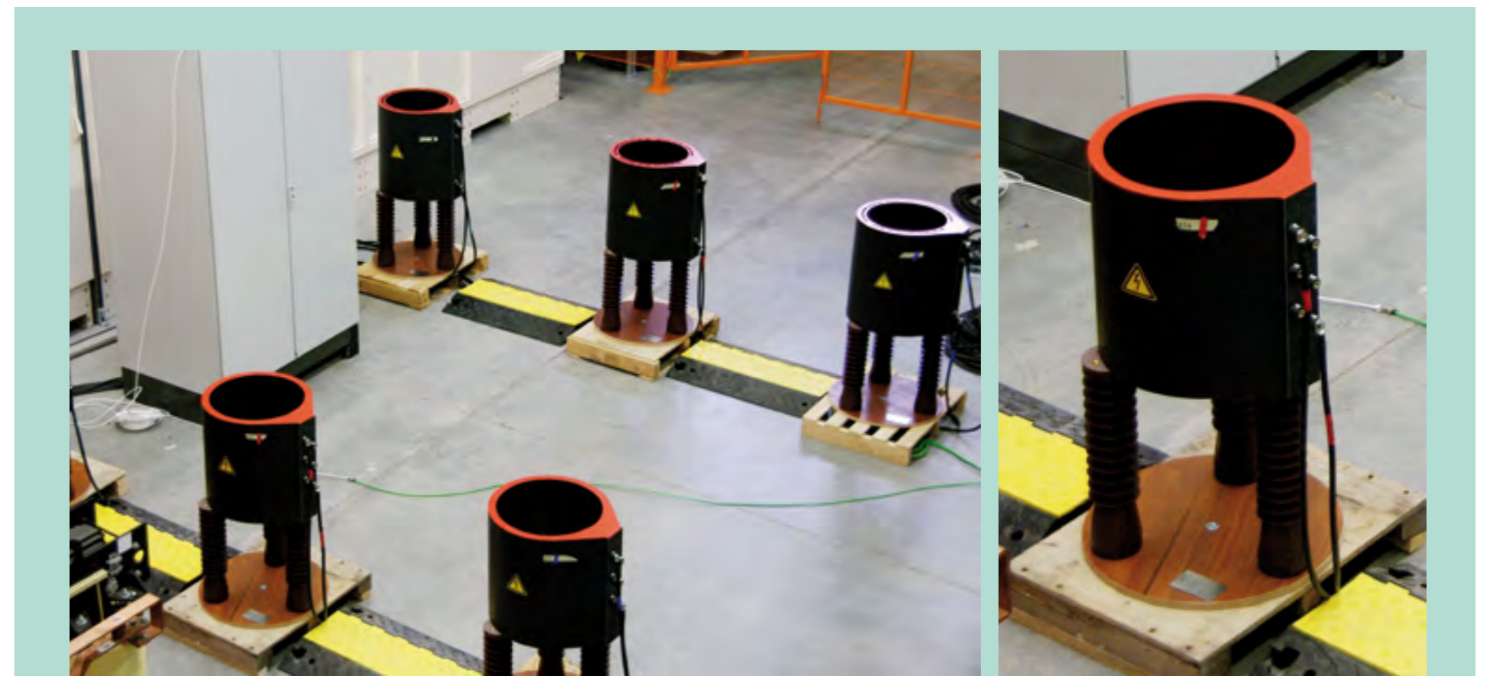
Aufbau der Niederspannungs-Kurzschlussstrom-Prüfstrecke im Prüflabor Netzintegration | Testzentrum SysTec
