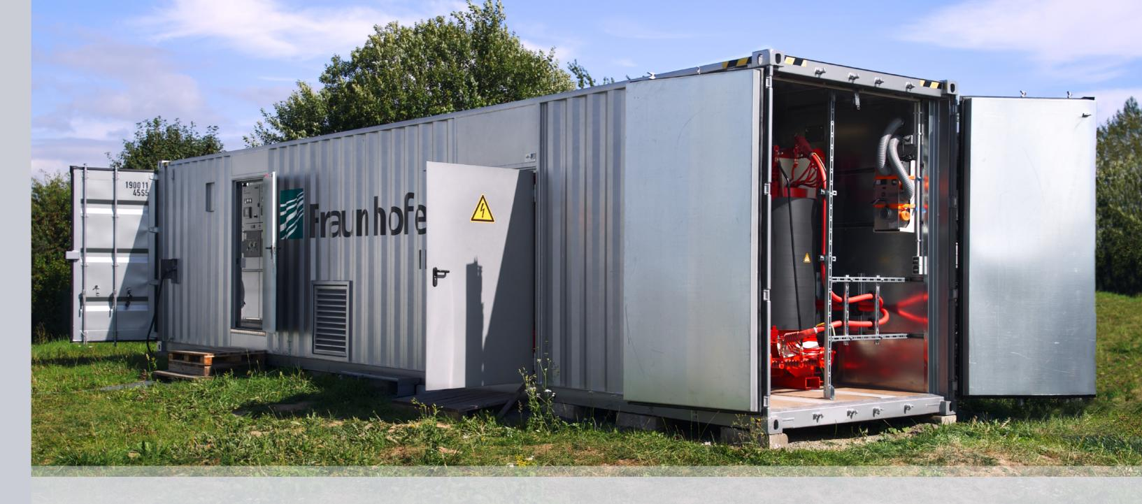
80-350 MVA SHORT-CIRCUIT POWER RANGE MOBI VOLTA TEST
