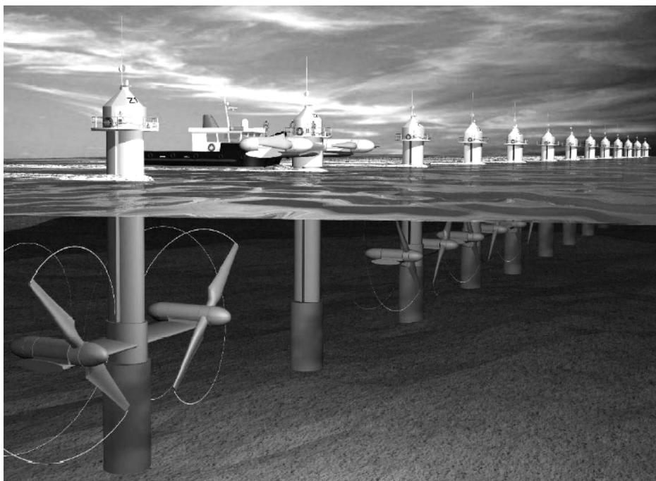
Abb. 10: Park aus mehreren SEAFLOW Turbinen (Doppelrotorkonzept)
