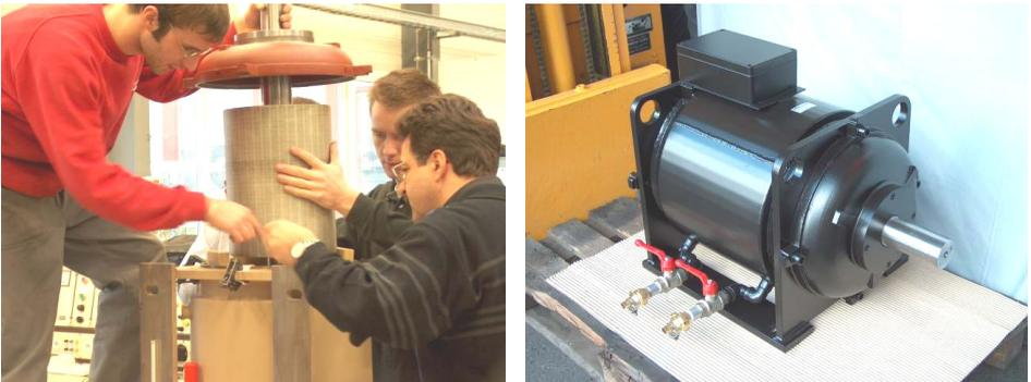
**Abb. 3: Laborprototyp des wassergekühlten PME-Generators bei der Montage durch Elmotec (li) und fertiggestellt (re)**
