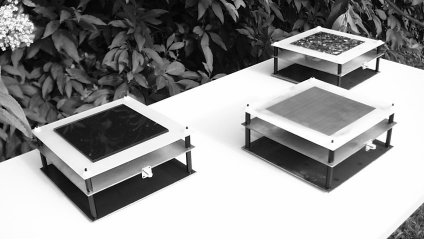
Abb. 6: Labormuster von schlitzzgekoppelten Patch-Antennen mit Solarzellen und linearer Polarisation [5], © Uni Kassel
