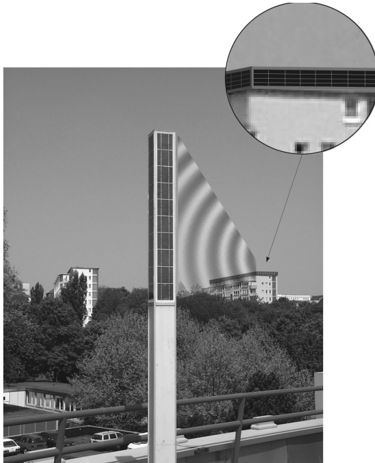
Abb.13: Computersimulation einer fassadenintegrierten solaren Planarantenne
