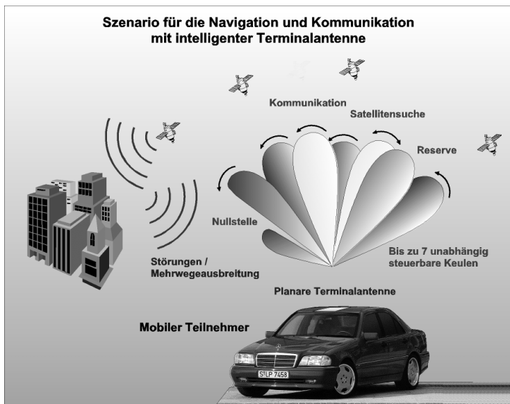
Abb. 11: Entwurf einer planaren Mehrkeulenantenne für den Automobilbereich, © DLR
