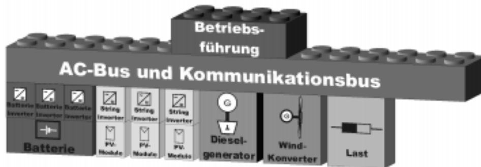
Abb. 2: Modulare Bausteine im Hybridsystem
