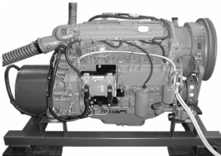
Bild 2.4.1: 80 kW Hilfsantrieb mit PME - Generator für einen Oberleitungsbus
