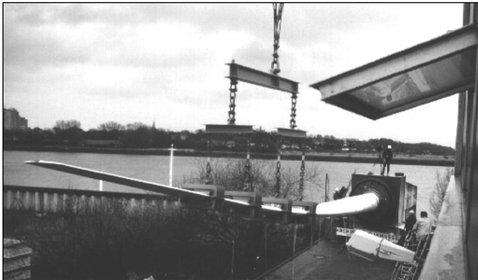
**Bild 5:** Rotorblatt im statischen Belastungstest
