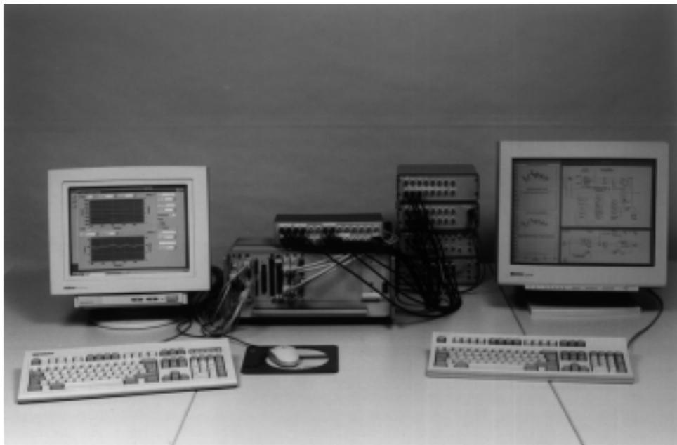
**Abb. 8: HIL-Simulationsumgebung zum Test der Regelung einer Windkraftanlage**
