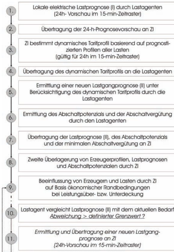
Abb. 6: Schema für den Informationsaustausch zur Einbindung von Lasten (Lastagent) in das Energiemanagement
