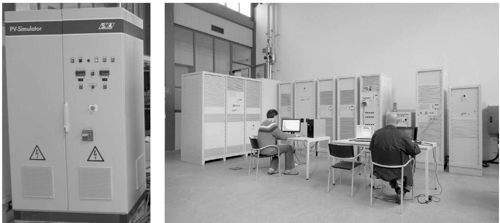
Abbildung 5: 100 kW<sub>p</sub> PV-Simulator (links); Spitzenberger & Spies Netzsimulator 3x30 kVA für die Nachbildung eines gestörten Netzverhaltens (rechts)
