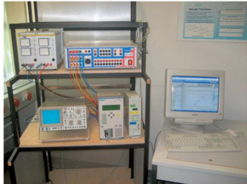
Abb. 6: Teststand für Schutzrelais
