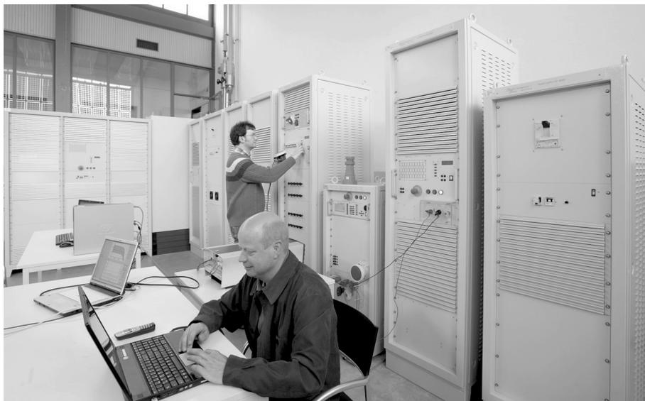
Abb. 5: Prüfeinrichtung für Netzzrückwirkungen bis 90 kVA sowie zur Simulation des PV-Generators bis 30 kW, © ISET
