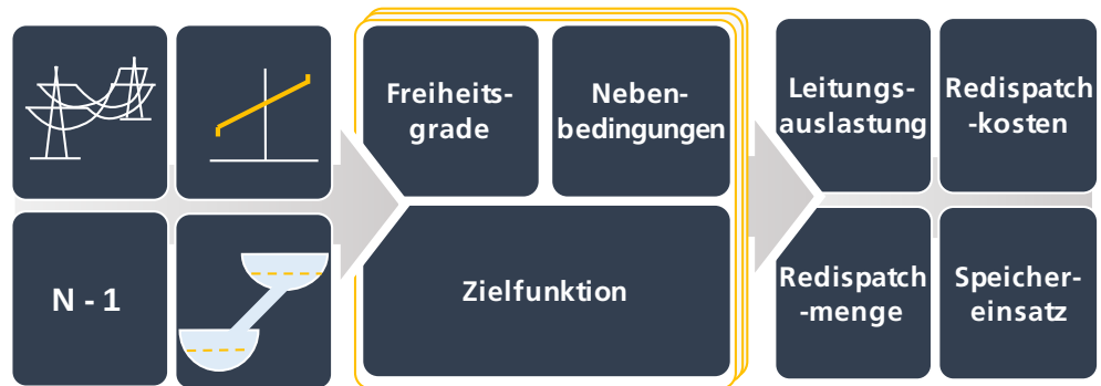
Abb. 5-9: Verfahrensablauf der Netzbetriebssimulation
