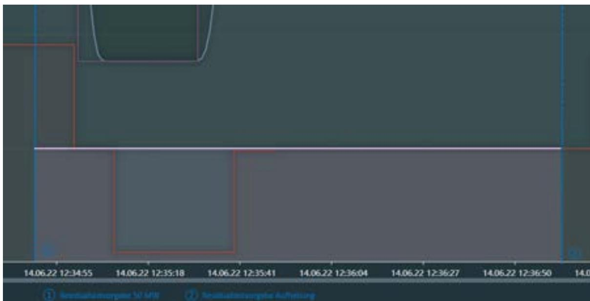
*Abbildung 45: Unter- und Oberschwinger der Residuallast (rot) bei konstantem Residuallast-Sollwert (rosa) (als Ergebnis vom Virtual Lab Testfall FLKW-VL-4)*
