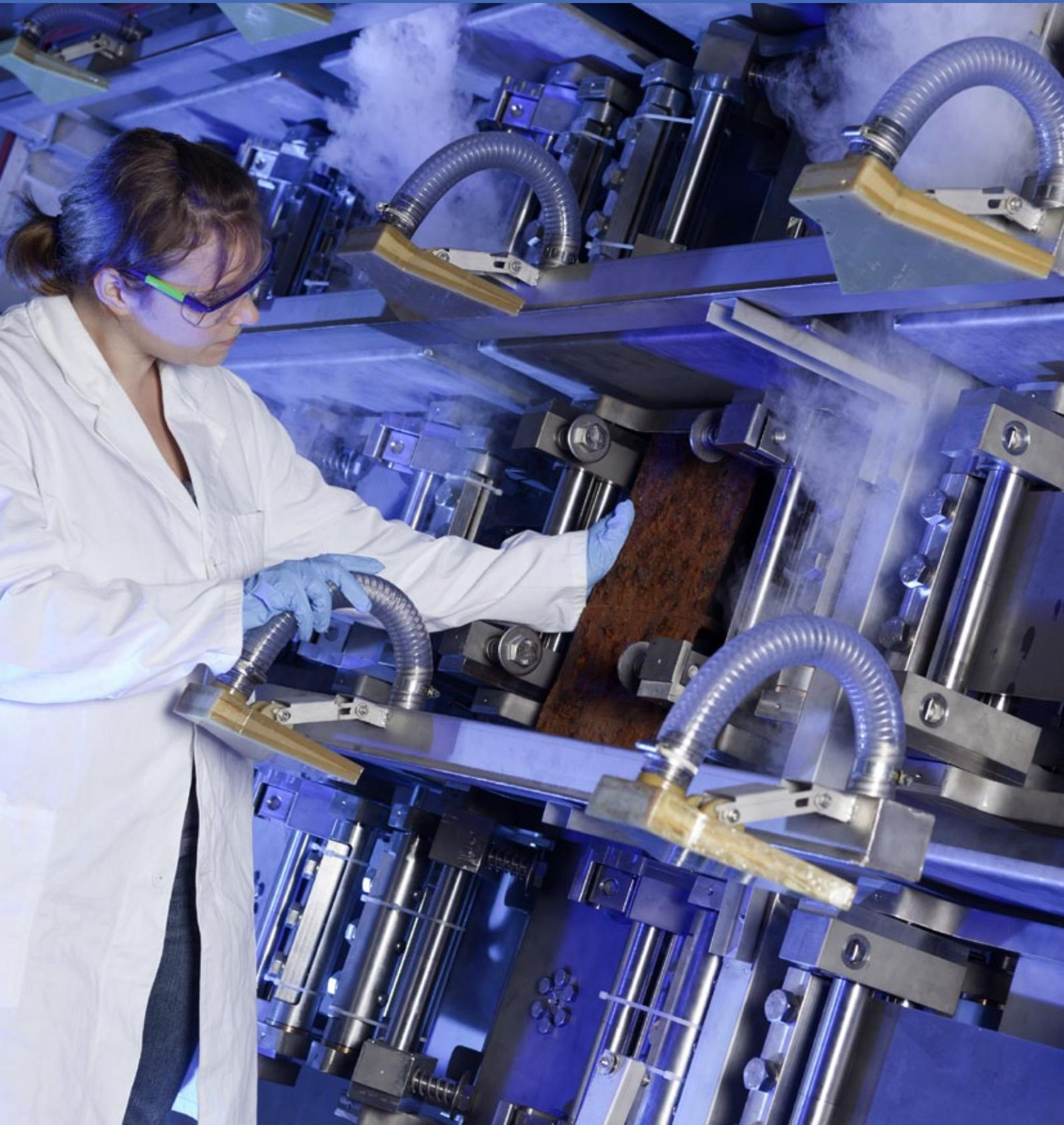
DIE ERGEBNISSE MEHRJÄHRIGER MATERIALTESTS AN AUSLAGERUNGSSTANDORTEN UNTERSTÜTZEN DIE ENTWICKLUNG UND VALIDIERUNG NEUER PRÜFVERFAHREN FÜR OFFSHORE-MATERIALIEN. DIE FELDVERSUCHE SIND SO ANGELEGT, DASS SIE EIN MÖGLICHSST BREITES SPEKTRUM POTENZIELLER ANWENDUNGSSTANDORTE MIT JEWEILS SPEZIFISCHEM BELASTUNGSPOTENZIAL ABDECKEN. AB 2011 ERWEITERT EINE OFFSHORE-TESTKAMMER, DIE MECHANISCHE UND KLIMATISCHE VERHÄLTNISSE ZEITGLEICH SIMULIERT, DAS PRÜFSPEKTRUM.
