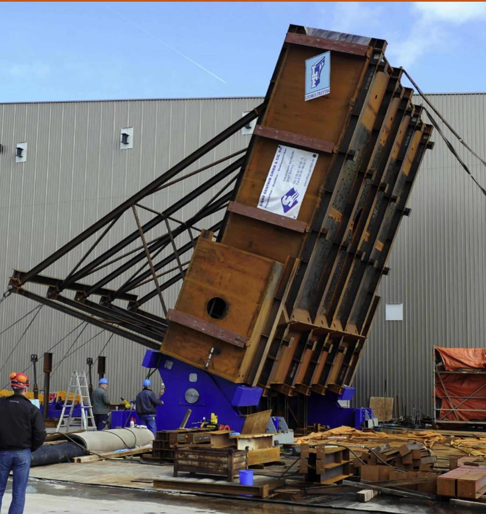
NEUE DESIGN- ODER MATERIALVARIANTEN VON ROTORBLÄTTERN WERDEN VOR DER SERIENFERTIGUNG GETESTET UND ALS VORBEREITUNG AUF DIE ZERTIFIZIERUNG GEGEBENENFALLS OPTIMIERT. EIN PRÜFSTAND FÜR BLATTLÄNGEN BIS 70-METER LÄNGE IST SEIT 2009 IN BETRIEB. AUFGRUND DER GUTEN AUSLASTUNG WIRD IM FRÜHJAHR 2011 EIN WEITERER PRÜFSTAND ERÖFFNET, IN DEM BIS ZU 90-METER LANGE ROTORBLÄTTER GEPRÜFT WERDEN KÖNNEN.
