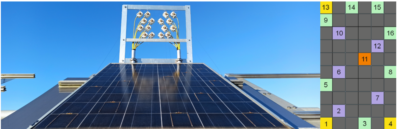
Abbildung 3. PV-Modul mit Elektroden; Abbildung 4. Position der Elektroden auf dem PV-Modul
