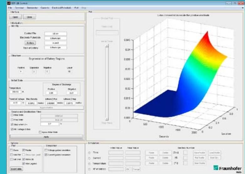
Simulationen und Hardware in the Loop Tests spielen in modernen Entwicklungsprozessen eine bedeutende Rolle, da sie eine große Zeit- und Kostenersparnis versprechen. Dies gilt vor allem auch im Bereich elektrischer Systeme, wo Speicher, wie Li-Ionen Batterien, in vielen Fällen eine zentrale Komponente darstellen. Das Fraunhofer IWES bietet für diese ein detailliertes Simulationsmodell unter dem Namen ISET-LIB.
