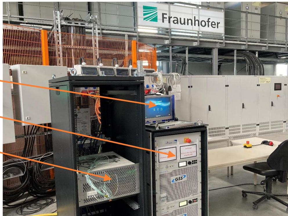
ROCOF-Prüfaufbau mit AC-Netzsimulator an einem netzbildenden Stromrichter
