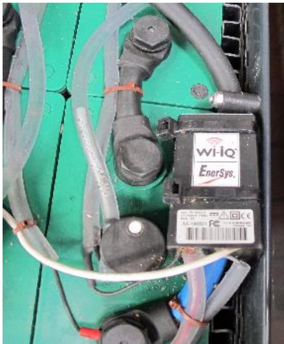
**Abb. 91** Messsystem Wi-IQ zur Erfassung von Batterie-Betriebsdaten
