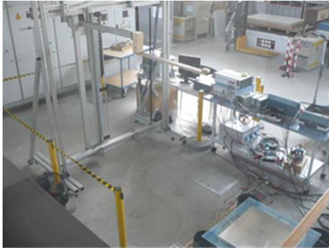
Abb. 64 Positioniereinrichtung x-y-z zur Messung der magnetischen Feldstärke (oben) sowie ein zu vermessender Laboraufbau eines Spulensystems (unten) im Labor
