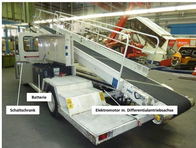
**Abb. 123** Elektrokomponenten des Förderbandwagens – Ansicht von hinten links (oben) und der Seiten (unten)
