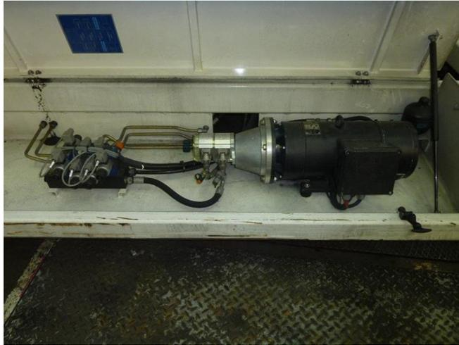
**Abb. 124 Elektrohydraulische Einheit mit Hydraulikventilen**
