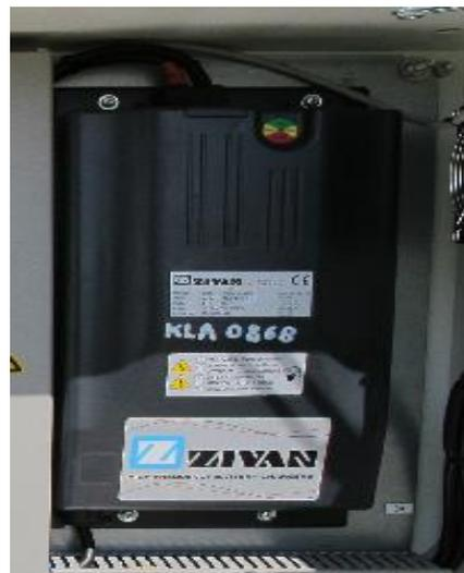
Abb. 107 Ansicht des Batterieladegerätes ZIVAN NG 3 mit seinen elektrischen Nenndaten
