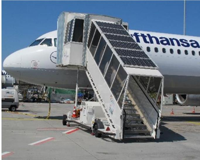
Abb. 103 Solarelektische Fluggasttreppe KPT0351 der Fraport
